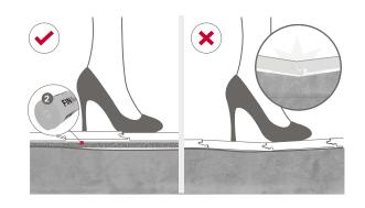
Vá pondo tiras de underlay e à medida que for precisando. Se o colocar todo ele poderá rasgar-se com a trasfega da montagem e perder assim as suas qualidades isolantes. A folha deve ser aplicada com uma superposição mínima de 20 cm ou 10 cm colando as folhas com uma fita adesiva de 50 mm e deve ser estendida sobre toda a superfície do chão e subir em todas as paredes uns 5-6 cm, que serão cortados ao colocar a base-rodapé.
