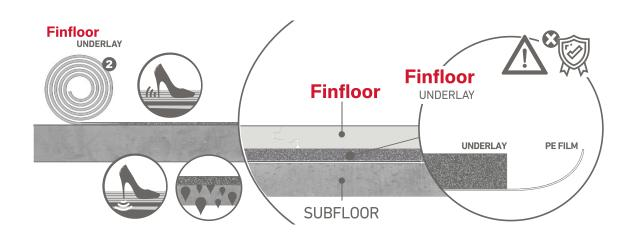
Por razões de nivelamento do subsolo e de isolamento, tanto acústico como quanto à humidade, COLOQUE SEMPRE UM UNDERLAY.
